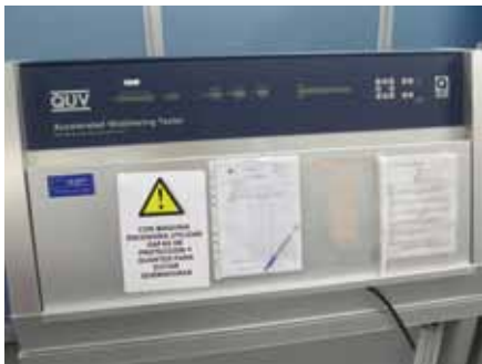
Figura 4. Equipo de envejecimiento climático
