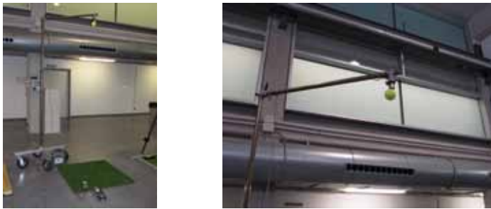
Figura 8. Equipo de evaluación del bote vertical de pelota
